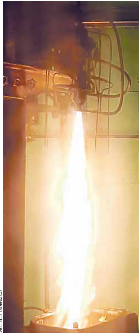
Проведение огневых испытаний ЖРД «Якайтис»
