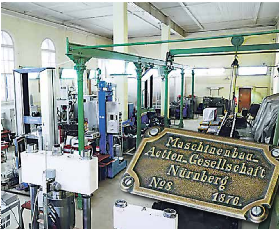
Механическая лаборатория им. Н. А. Белелюбского: справа — фирменная заводская табличка горизонтального гидравлического пресса, изготовленного в Нюрнберге в 1876 г. Этот ценный объект истории техники до сего дня используется для проведения испытаний
