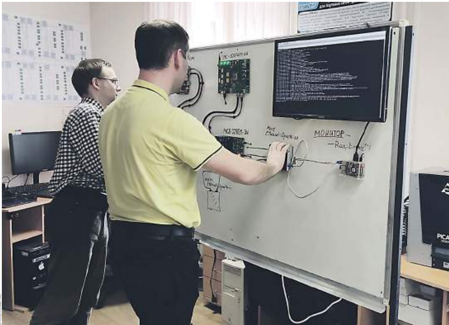
Аэрокосмический стенд SpaceWire для сертификации и тестирования
