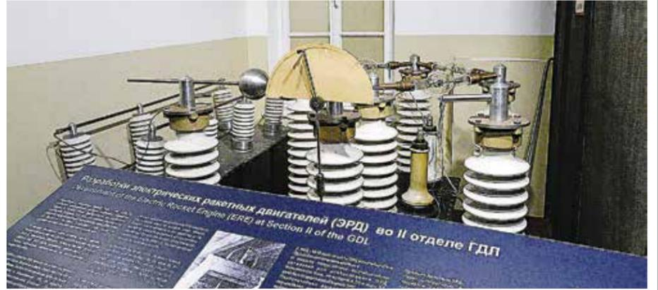
Музей космонавтики и ракетной техники. Испытательный стенд для определения тяги электроракетного двигателя конструкции В. П. Глушко (реконструкция)
