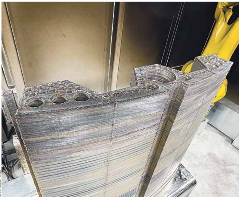
Фрагмент выгородки внутрикорпусного устройства водо-водяного энергетического реактора по технологии прямого лазерного выращивания
